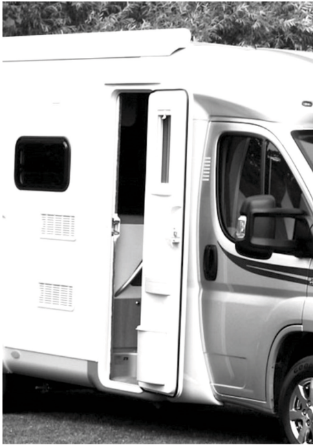
Fig. 14 : Cellule, porte d'accès
