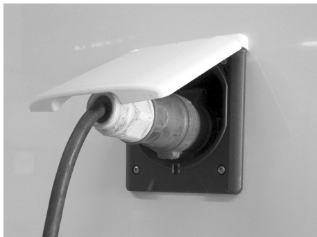
Fig. 56 : Branchement électrique sur le secteur
