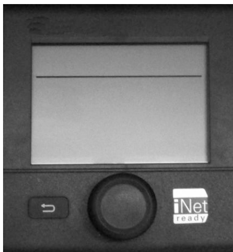
Fig. 71 : Unité de commande digitale TRUMA CP Plus
