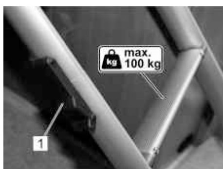
Fig. 130 : Verrouillage (1) de l'échelle d'accès
