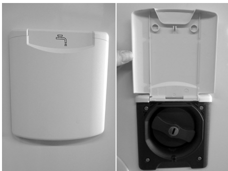
Fig. 78 : Manchon de remplissage d'eau fraîche
