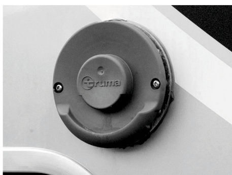
Fig. 74 : Conduit d'évacuation des gaz brûlés (sur la paroi)
