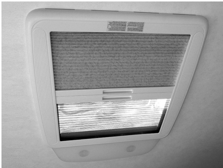
Fig. 92: Exemple de store rouleau combiné du lanterneau
