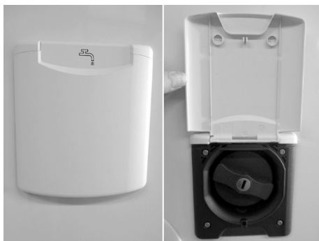
Fig. 20 : Manchon de remplissage d'eau fraîche
