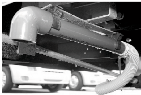
Fig. 84 : Exemple de manchon de vidange
