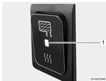
Fig. 68 Interrupteur Marche/Arrêt sur Marche
