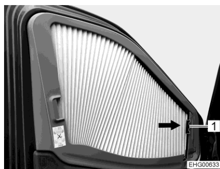
Fig. 19 Fenêtre latérale avec store plissé coulissant
