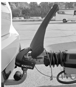
Fig. 13: Attacco sferico aperto, stabilizzazione disattivata
