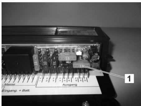
Fig. 68: Illuminazione di emergenza 12 V
