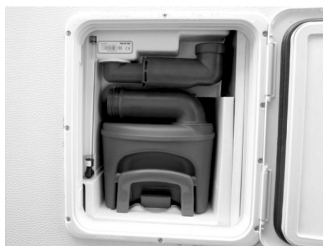
Fig. 57: Serbatoio acque nere con bocchettone di riempimento dell'acqua di risciacquo
