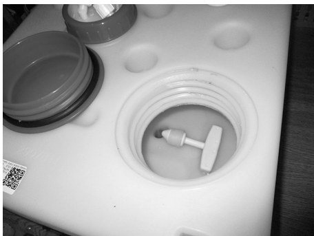
Fig. 103: Tappo di scarico del serbatoio dell'acqua fresca
