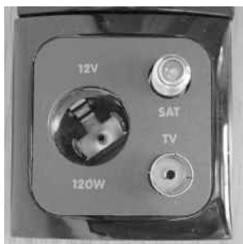
Fig. 77: Presse da 12 V, esempio
