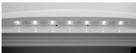
Fig. 75: Luce tendalino con diodi luminosi
