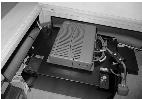
Fig. 70: Copertura batteria con centralina per Mover (optional)
