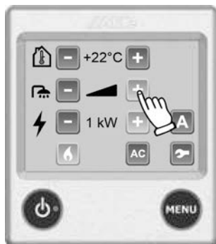
Fig. 150: Più acqua calda
