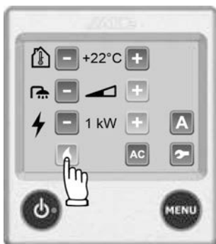
Fig. 151: Riscaldamento a gas
