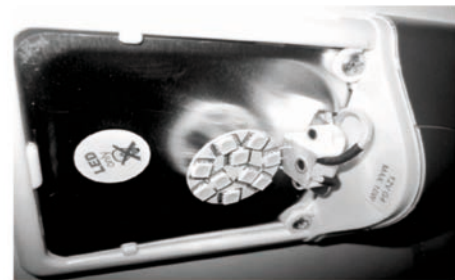
Fig. 194: Inserimento corpo illuminante a LED
