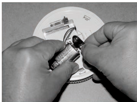
Fig. 203: Sostituire la batteria rettangolare
