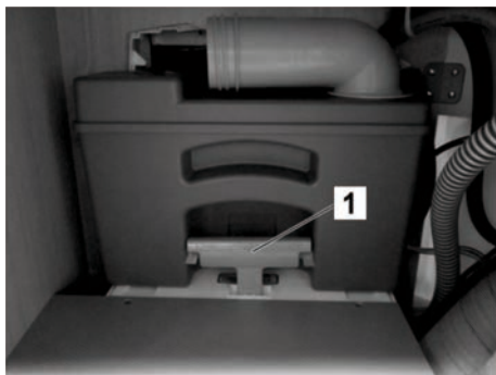
Fig. 179: Serbatoio acque nere nel vano WC
