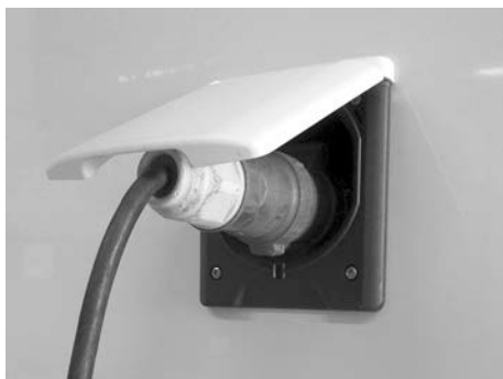
Fig. 60: Allacciamento alla rete elettrica
